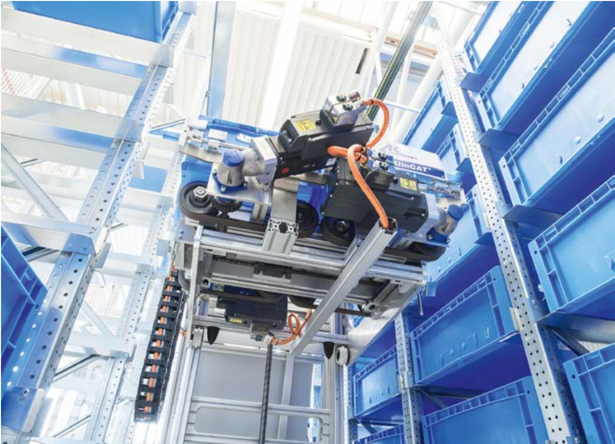
Ein Klinkcat-Multilevel-Shuttlelager ist für Frischwaren vorgesehen.
